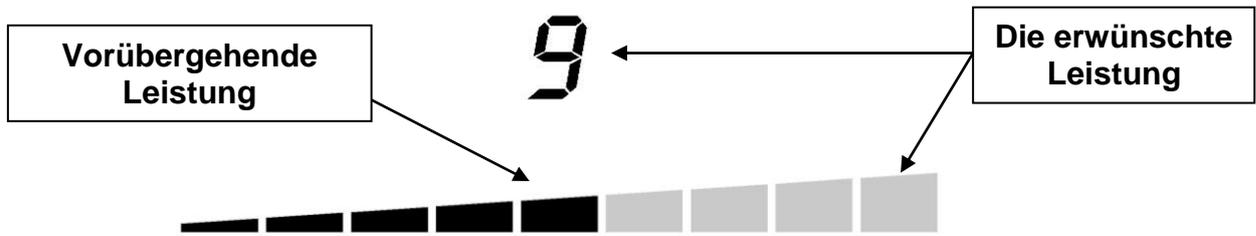
Die Segmente der Anzeige werden nach und nach eingeschaltet, bis die gewünschte Leistung erreicht ist.
