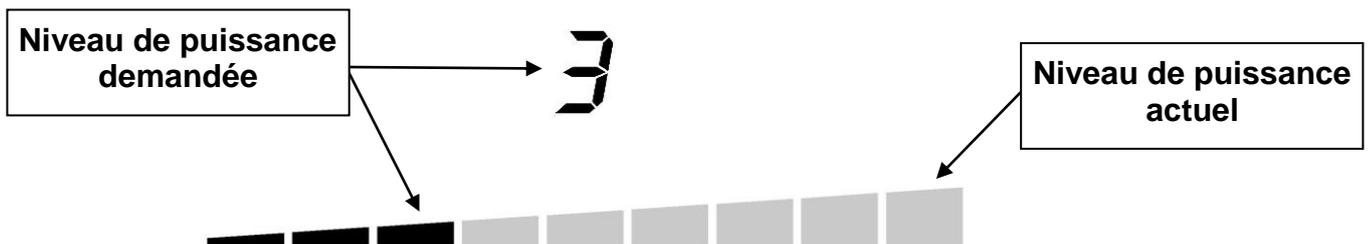
Les segments de l'affichage du niveau de puissance s'éteignent un par un jusqu'au niveau de puissance demandée.
