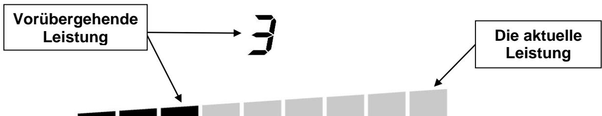
Die Segmente der Anzeige werden nach und nach ausgeschaltet, bis die gewünschte Leistung erreicht ist.
