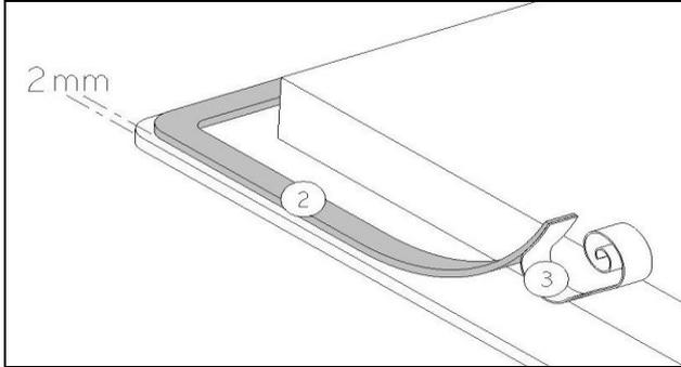
Die Dichtung (2) nach Abnehmen der Schutzfolie (3) mit 2 mm Abstand der Ausserkannte des Glases aufkleben.
