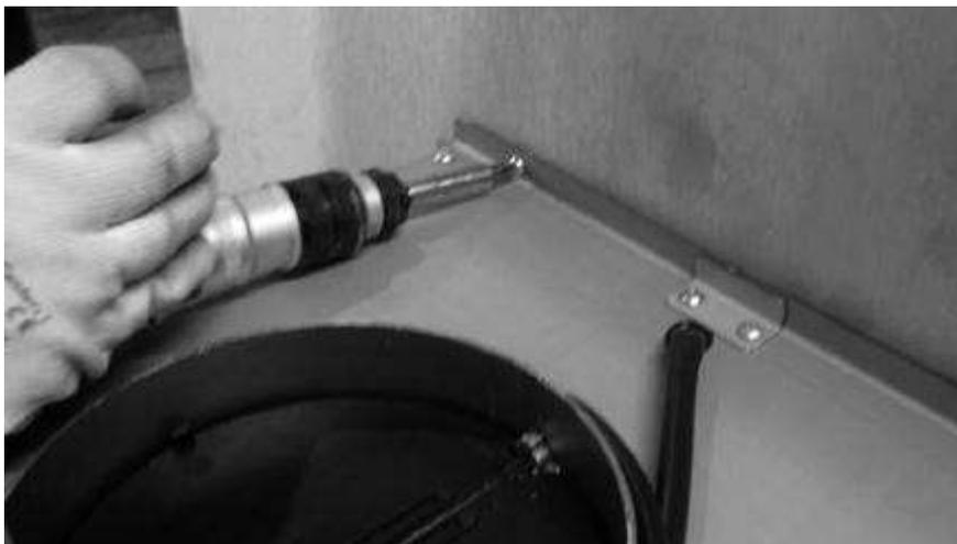
3 - Montare sulla parte aperta del motore una delle due placche in plastica utilizzando le n° 8 viti e gli 8 dadi in dotazione.
